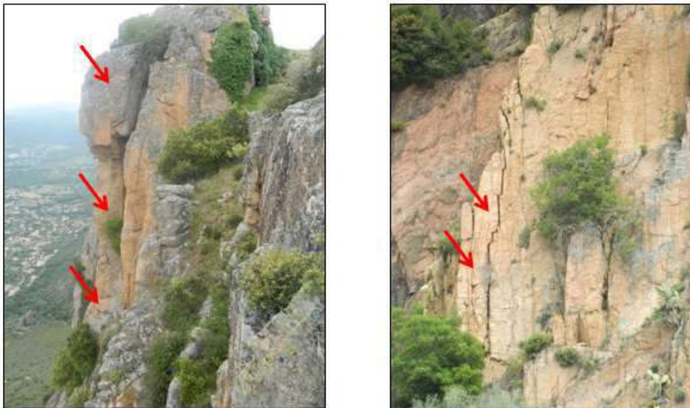
Figure 22: Exemples de rupture possible de colonnes en pied (à gauche partie sommitale du Rocher des Gozzi, à droite secteur de Piscia Rossa)
